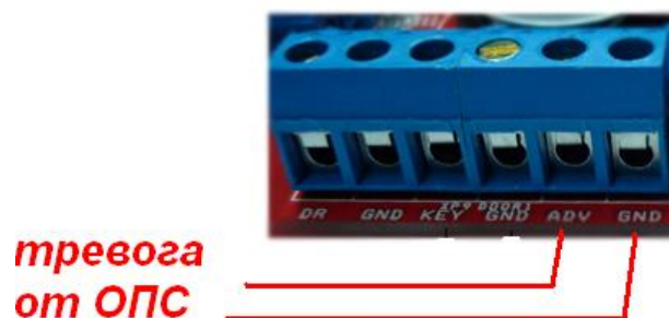
Рисунок 3 - Подключение внешнего сигнала тревоги
